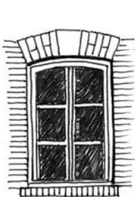
Fenêtre à deux ouvrants découpés chacun en trois carreaux.
