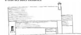
La façade nord n'est pratiquement pas ouverte. Des annexes se sont implantées sur cette façade, renforçant ainsi son isolation thermique.
