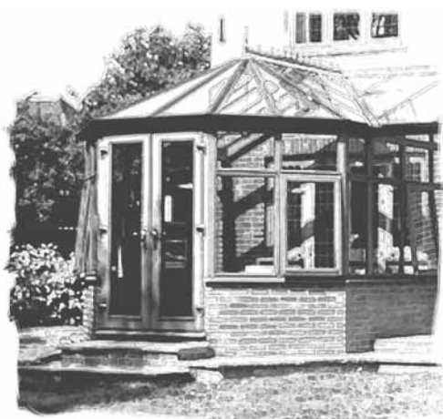
Véranda aux murs et toit vitrés, à éviter au sud en raison de l'effet de serre.
