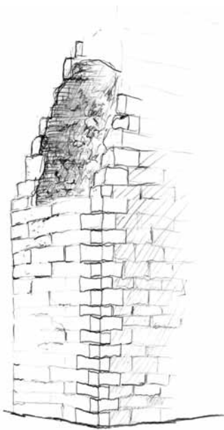
Maçonnerie de moellons* appareillés* et blocage* interne.
