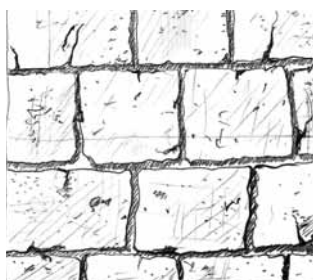
Moellons* en appareillage* assisé.
